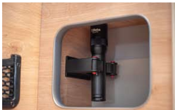
podręczna latarka ładowana z gniazda 12V zamocowana w łatwo dostępnym uchwycie
