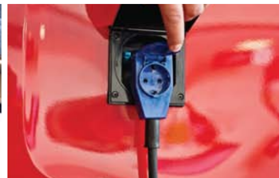
zewnętrzne gniazdo CEE (dla SHORT po lewej, dla LONG po prawej stronie) z możliwością wyprowadzenia gniazda 230V pod markizą
