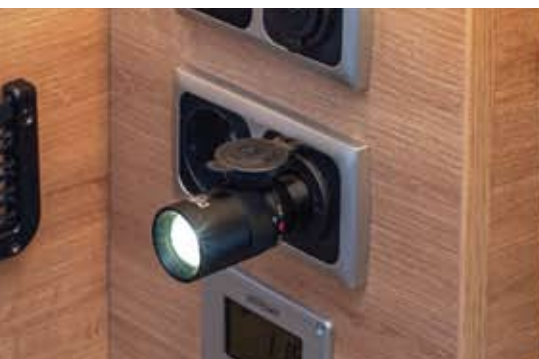
podręczna latarka ładowana z gniazda 12V zamocowana w łatwo dostępnym uchwycie
